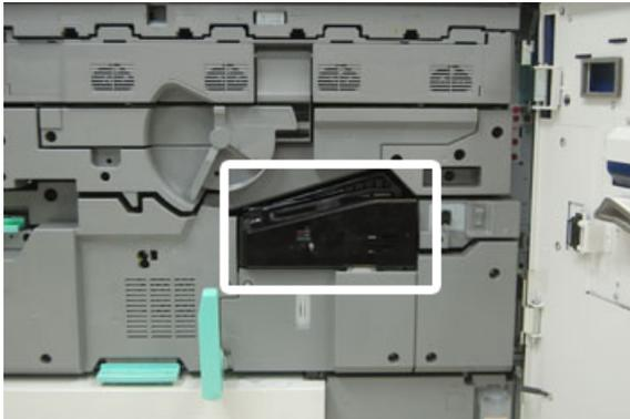
4. Retirer le panneau avant du module four en utilisant le pilote T10 Torx pour dévisser la vis de fixation au centre du panneau.
