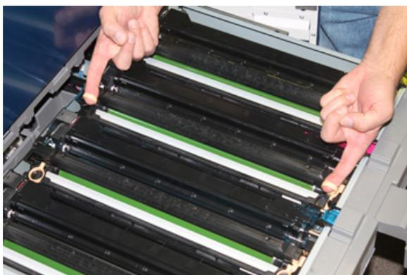
**!** **Attenzione:** Le cartucce sono sensibili alla luce. Durante la sostituzione delle cartucce, non lasciare aperto il cassetto delle cartucce fotoricettore per più di un minuto. Esporre le cartucce fotoricettore alla luce solare diretta o a una forte di luce artificiale fluorescente per più di un minuto può causare difetti nella qualità dell'immagine.
