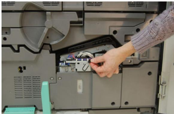
8. Posizionare il coperchio anteriore del fusore sul gruppo, quindi serrare la vite saldamente.
