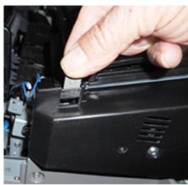
6. Individuare i due connettori bypass del fusore nel kit. Il ponticello del resistore nero (sinistro) è utilizzato per la gamma di valori numero 2, e il ponticello del resistore blu (destra) è usato per la gamma di valori numero 3. Per i numeri della gamma, consultare la tabella dei connettori bypass nella sezione [Informazioni sulla larghezza del fusore](#).
