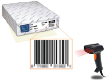
Se il codice a barre è già registrato nel PredictPrint Cloud Server, dopo la scansione del codice a barre, la Configurazione guidata supporti visualizza le proprietà dei supporto e la stampante riceve automaticamente le impostazioni per configurare al meglio i valori di stampa per il lavoro.
