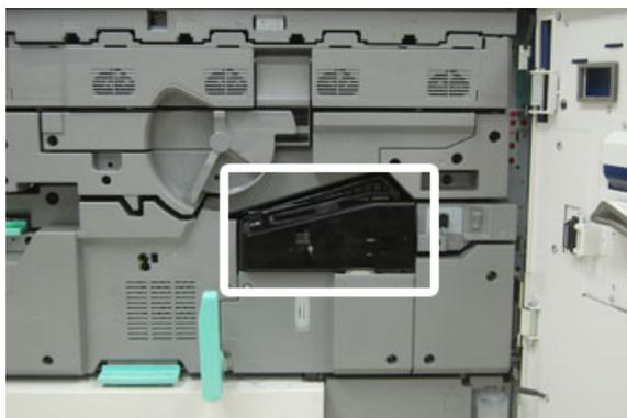
4. Rimuovere il coperchio anteriore del fusore usando un cacciavite Torx T10 per svitare l'unica vite al centro del coperchio.
