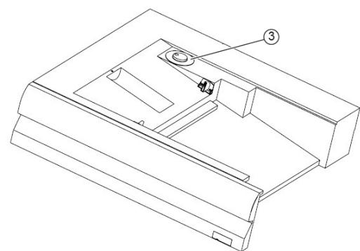
1. Sett av/på-bryteren i på-stilling for å slå på Xerox® XLS automatisk matesett. Av/på-bryteren er på baksiden av fleraksinnleggsmagasinet.
