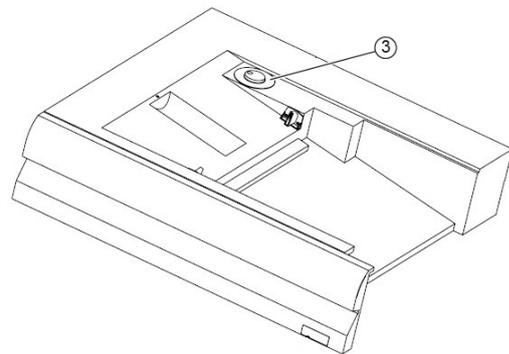
1. Para ligar o Kit de Alimentação Automática Xerox® XLS, mova o interruptor de alimentação para a posição Ligado. O interruptor de alimentação está localizado na lateral traseira da bandeja do Módulo de inserção de múltiplas folhas.
