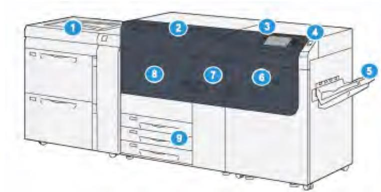
1. Alimentador de alta capacidade superdimensionado avançado (Bandejas 6 e 7), com a Bandeja 5 (Manual)
