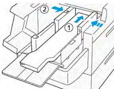
7. Segure a guia lateral traseira de XLS pela alça e mova-a até tocar levemente nas bordas do papel (1). Coloque a guia lateral dianteira de XLS para ajustar ao papel carregado (2). A guia lateral dianteira de XLS é removível. Instale a guia lateral dianteira na direção que garante que a superfície metálica toque no papel.
