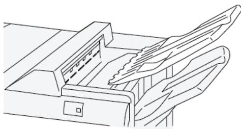
2. Coloque o acessório alinhador da bandeja superior na bandeja superior do Módulo de acabamento PR. Ajuste o alinhamento entre a bandeja superior e o acessório alinhador da bandeja.
