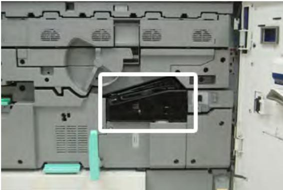
4. Retire a tampa dianteira do fusor usando a chave T10 Torx para desaparafusar o parafuso de montagem no centro da tampa.
