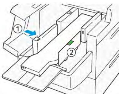
8. Feche as duas tampas (1) e, em seguida, aguarde até que a placa inferior seja levantada. Coloque a guia final de XLS para ajustar ao papel carregado (2). A guia final de XLS é removível. Instale a guia final na direção que garante que a superfície metálica toque no papel.
