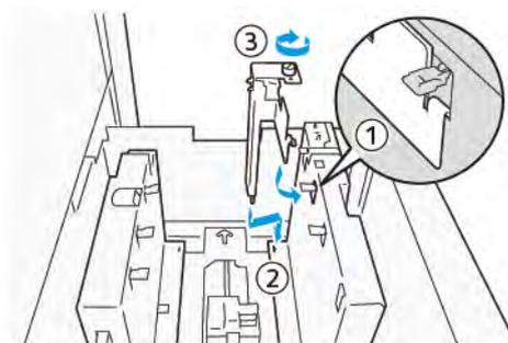
6. Insira a guia A na fenda na parte interna (1) e na parte inferior (2) da bandeja. Aperte o parafuso para prender a guia (3).
