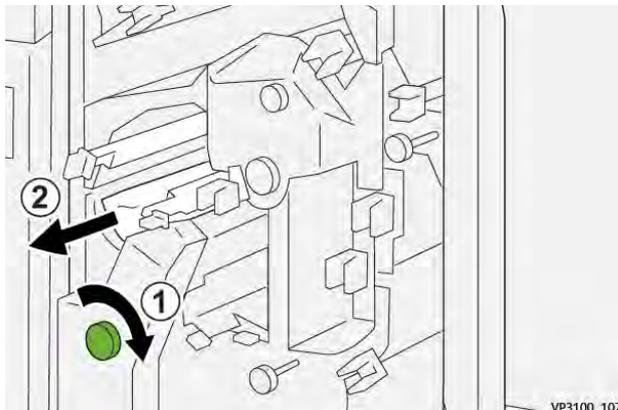
4. Se houver dificuldade para remover a folha atolada, segure a borda superior do lado interno à direita da folha e puxe-a suavemente para removê-la.
