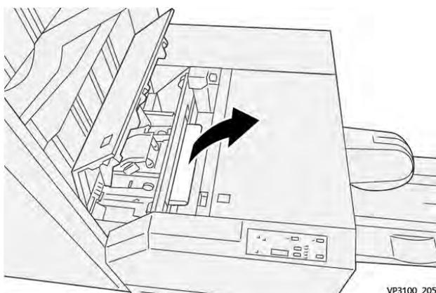
3. Se for difícil remover o papel atolado, abra a tampa dianteira do módulo de acabamento.
