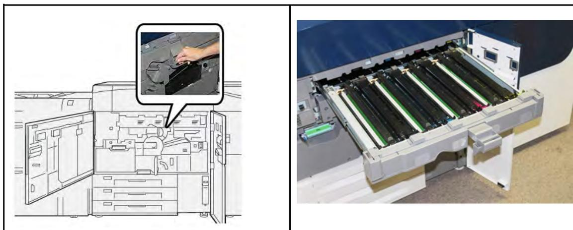
5. Remova o cartucho do fotorreceptor antigo, mantendo os anéis fornecidos em ambas as extremidades do cartucho do fotorreceptor e levantando ligeiramente.
