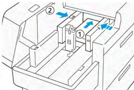
5. Coloque as folhas restantes na bandeja e depois alinhe as bordas do papel na direção mostrada (1). Mova a guia final até tocar levemente nas bordas do papel (2). Ajuste as guias do papel pressionando a alavanca de liberação da guia e movendo as guias cuidadosamente até que elas toquem levemente nas bordas do papel.
