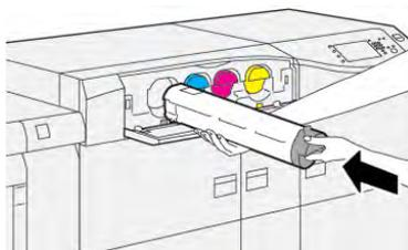
8. Feche a tampa do toner. Se a tampa não fechar completamente, verifique se o cartucho está na posição de travamento e está instalado no local de toner adequado.
