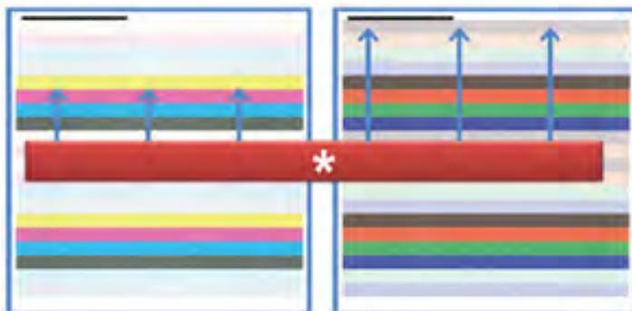
\* Verifique se há densidade uniforme e consistente em todas as barras de cores, conforme indicado pelas setas na ilustração acima.
