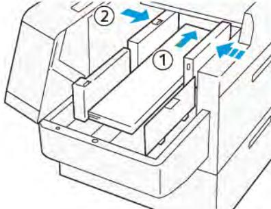
5. Segure a guia lateral traseira de XLS pela alça e mova-a até tocar levemente nas bordas do papel (1). Coloque a guia lateral dianteira de XLS para ajustar ao papel carregado (2). A guia lateral dianteira de XLS é removível. Instale a guia lateral dianteira na direção que garante que a superfície metálica toque no papel.
