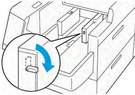
3. Se a guia final estiver guardada, abra o obturador da guia final e gire a guia final para travar na posição vertical.
