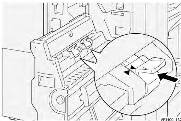
5. Empurre suavemente a **Unidade 3 de grampeamento na lombada** para o módulo de acabamento até que ela pare.
