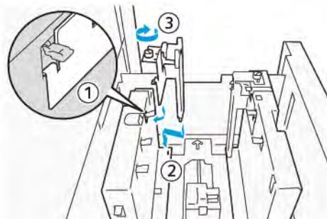
7. Coloque 100 a 500 folhas de papel e depois alinhe as bordas do papel na direção mostrada (1). Para material pré-impreso, coloque o papel com a face impressa voltada para cima. Segure as guias laterais pela alça e mova-as até tocarem levemente nas bordas longas do papel (2).
