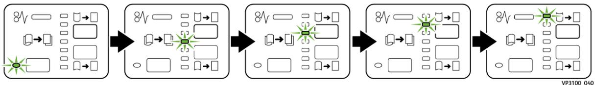
Pressionar o botão de curvatura para baixo altera os níveis de correção de curvatura, como mostrado:
