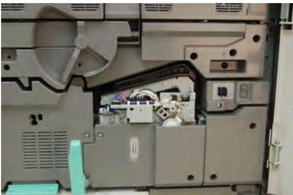
5. Localize o grampo identificador de fusor no conjunto do fusor e, usando um marcador, escreva no identificador a largura do fusor que está sendo usada.
