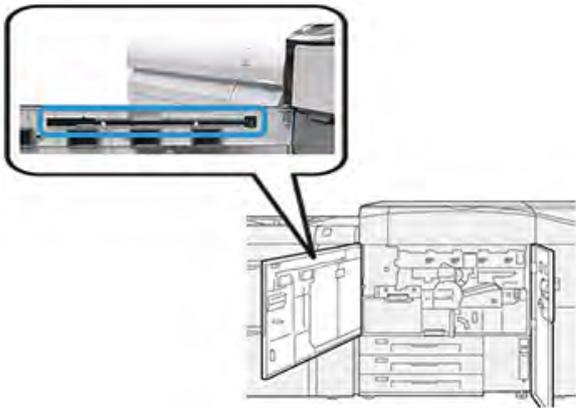
3. Certifique-se de que a almofada na ponta do bastão esteja limpa. Várias almofadas de limpeza são fornecidas com a haste de limpeza quando a impressora é instalada.
