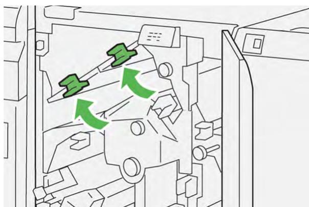
6. Se houver dificuldade para remover os atolamentos de papel, mova a alavanca **1d** para cima (1) e a alavanca **2a** para a esquerda (2).
