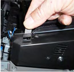
6. Localize os dois conectores manuais de fusor no kit. A ligação em ponte do resistor preto (à esquerda) é usada para o valor na faixa 2 e a ligação em ponte azul (à direita) representa o valor na faixa 3. Para obter os Números de faixas, consulte a tabela conector manual em [Informações sobre largura do papel do fusor](#).
