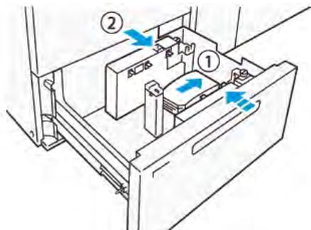
4. Ao colocar envelopes repetidamente, expanda a guia lateral e depois repita o processo de carregamento para cada maço de aproximadamente 100 envelopes. Quando usar o Kit de cartão postal, alinhe os envelopes colocando a mão entre a guia lateral e os envelopes.
