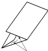
Uma dobra em C tem duas dobras que criam uma saída de três painéis. A saída com dobra C é entregue à bandeja de saída com dobra C/Z.
