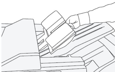
3. Para obter um melhor empilhamento da mídia, ajuste as guias móveis do documento no acessório alinhador da bandeja superior. Para alinhar as guias do documento com a mídia, coloque a mídia no Acessório Alinhador da Bandeja Superior e ajuste as guias.
