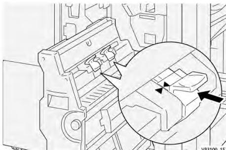
6. Empurre suavemente a **Unidade 3 de grampeamento na lombada** para o módulo de acabamento até que ela pare.
