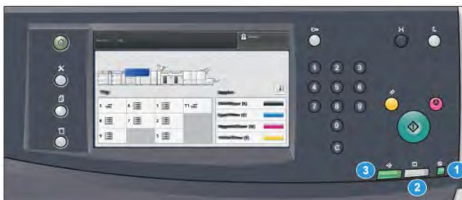
Há três luzes de status na impressora diretamente abaixo do Painel de controle. Da direita para a esquerda, são elas:
