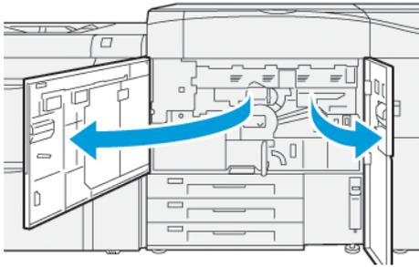
2. Localize e remova a ferramenta de suporte de limpeza armazenada no painel interno da porta dianteira esquerda.
