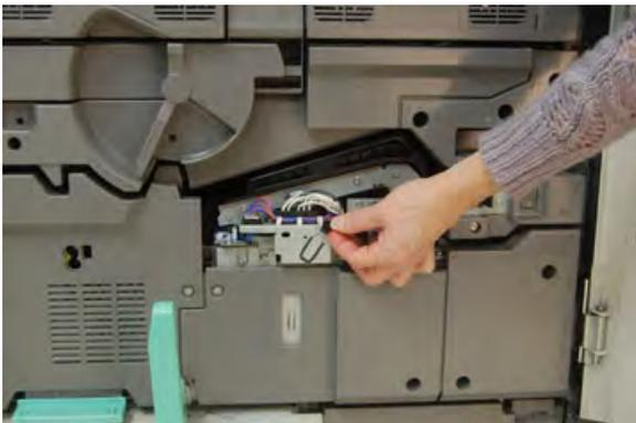
8. Posicione a tampa dianteira do fusor de volta no conjunto e aparafuse firmemente no lugar.
