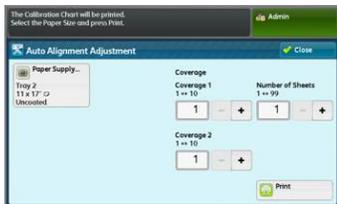
La Cobertura 1 es para la Cara 1, y la Cobertura 2 es para la Cara 2 de la página. Normalmente puede dejar la cobertura configurada en 1. Sin embargo, si tiene problemas de alineación reiteradamente en los trabajos de impresión con una gran cobertura de área, puede ir aumentando este valor hasta 10.
