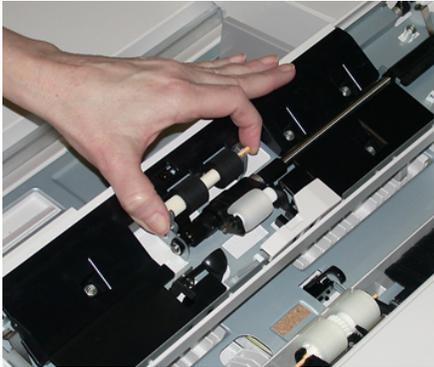
4. Retire y sustituya el rodillo empujador usando la misma técnica.
