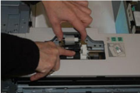
4. Coloque el rodillo nuevo apretando ambos extremos del eje de metal y, a continuación, empuje hacia abajo la pestaña negra e inserte y libere los extremos del rodillo en las muescas.
