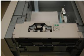
3. Extraiga el rodillo empujador presionando la brida negra hacia abajo con una mano (lo cual eleva el rodillo) y oprimiendo los dos extremos del eje metálico con la otra mano. Levante y extraiga el rodillo empujador.
