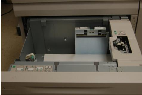
2. Vea el compartimento del rodillo de alimentación en el panel del lado derecho del módulo.
