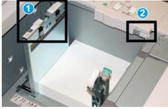
1. Palanca de ajuste de descentrado posterior
