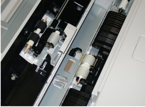
3. Extraiga y sustituya el rodillo de alimentación oprimiendo el eje metálico y levantándolo hacia afuera.
