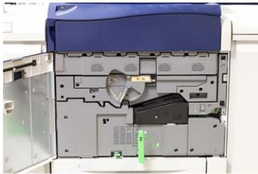
3. Ruotare e girare la maniglia R1-R4 del cassetto delle cartucce fotoricettore in posizione di sblocco.
