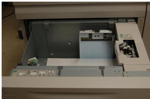
Secondo alimentatore ad alta capacità per grandi formati (OHCF) (OHCF/vassoi 8 e 9)
