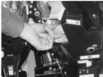
4. Controllare se all'interno della stazione di finitura sono rimasti punti metallici e rimuoverli, se necessario.
