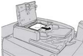
4. Se vengono visualizzate delle istruzioni che richiedono di aprire la copertura interna, sollevare la leva e aprire la copertura interna. Rimuovere il documento inceppato.
