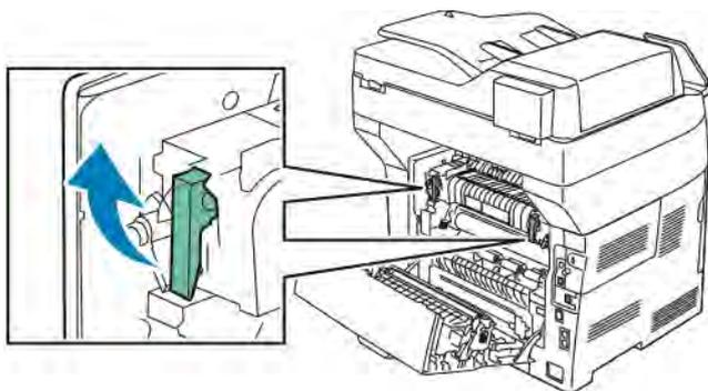
3. Finn de to grå fikseringsbryterne, og skyv deretter en av dem til innstillingen for konvolutter.
