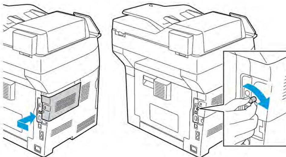
6. Du kan kople skriveren direkte til datamaskinen med en USB-kabel, eller via et nettverk ved hjelp av en Ethernet-kabel.
