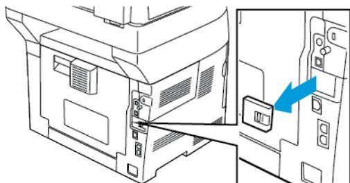
3. Før hånden inn i skriveren og trekk i utløserhendelen. Ta tak i den trådløse nettverksadapteren med den andre hånden og trekk den forsiktig vekk fra skriveren.
