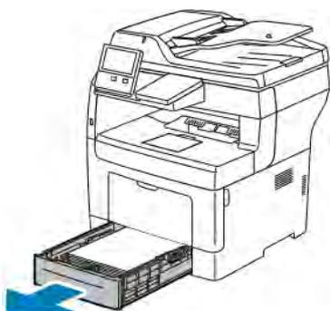
4. For å fjerne magasinet løfter du fremre ende av magasinet litt opp, før du trekker det ut av skriveren.
