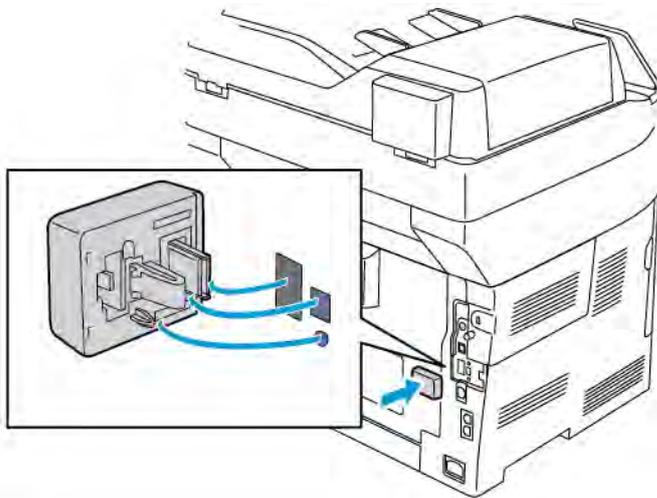
**!** **Forsiktig:** Hvis du trekker hardt i adapteren, kan du skade den. Når adapteren er installert, må du følge instruksjonene for fjerning av *trådløs nettverksadapter* hvis du har behov for å fjerne den. Se *Fjerne en trådløs nettverksadapter* hvis du vil ha mer informasjon.
