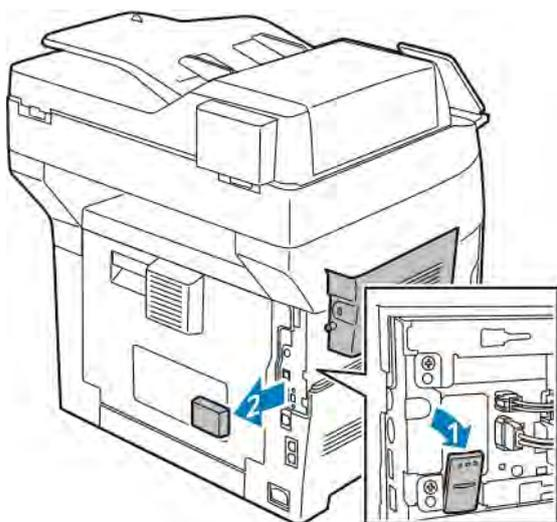
**!** **Forsiktig:** Trekk ikke for hardt i den trådløse nettverksadapteren. Hvis du har brukt utløserhendelen riktig, vil adapteren lett komme ut. Hvis du trekker hardt i en sikret adapter kan du skade den.
