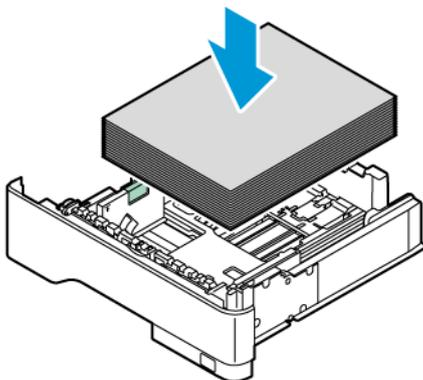
6. Для соответствия размеру бумаги отрегулируйте направляющие бумаги по длине и ширине. Сожмите фиксаторы направляющих, а затем продвиньте направляющие бумаги внутрь, пока они не коснутся бумаги.
