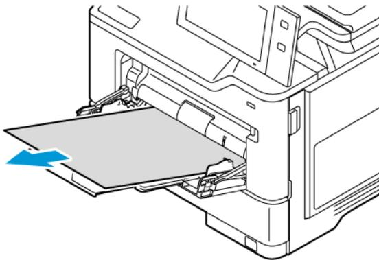
2. Если бумага порвалась, проверьте, не осталось ли обрывков внутри принтера.
