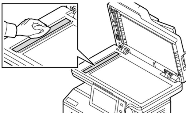
5. Очистите и протрите насухо всю область подкладки стекла экспонирования автоподатчика оригиналов.
