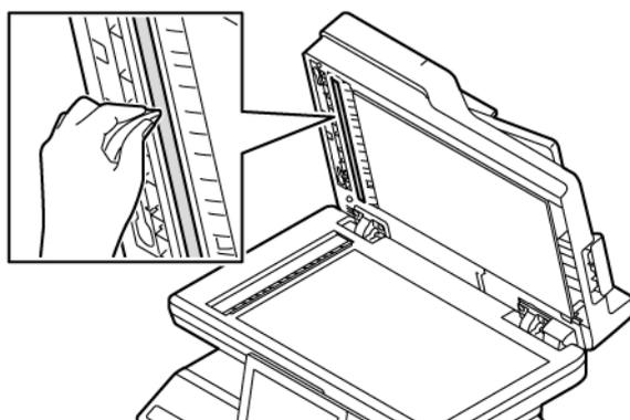
6. Досуha протрите поверхности стекла экспонирования и стекла сканирования через автоподатчик.
