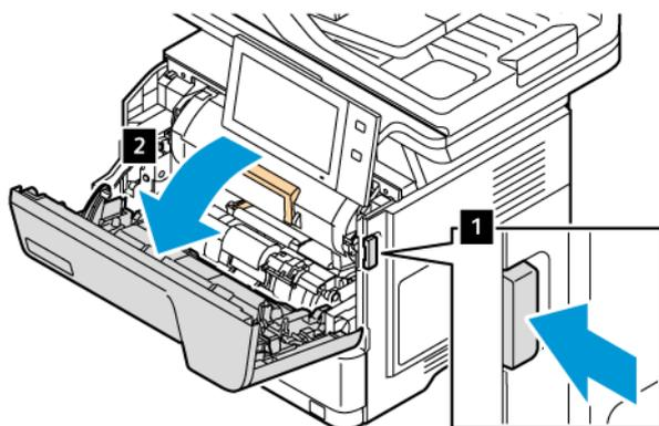
2. Крепко возьмитесь за ручку тонер-картриджа и извлеките использованный тонер-картридж из принтера.
