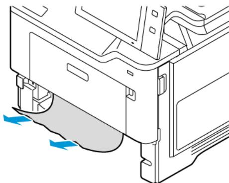
4. Если бумага порвалась, полностью снимите лоток и проверьте, не осталось ли обрывков бумаги внутри принтера.
