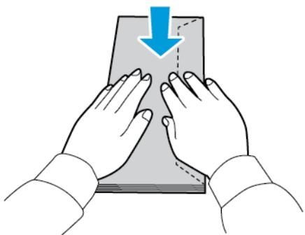
3. Загрузите конверты в лоток. Конверты с клапаном по длинной стороне загружаются закрытым клапаном вниз. Держите клапаны с левой стороны.
