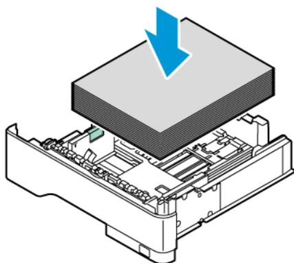
4. Чтобы задействовать фиксатор тонкой настройки, возьмитесь за рычаги большим и указательным пальцами и сдвиньте направляющие по направлению внутрь.
