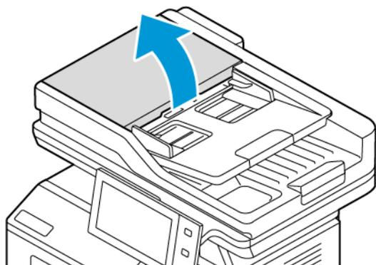
2. Поворачивая ролики, протирайте их чистой, безворсовой тканью, смоченной в воде.
