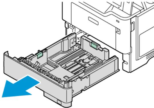
2. Извлеките бумагу из лотка. Сожмите направляющие рычаги, а затем сдвиньте направляющие длины или ширины наружу до упора.
