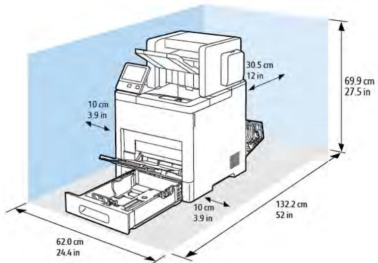
**Габаритные требования для принтера с дополнительным податчиком на 550 листов**
