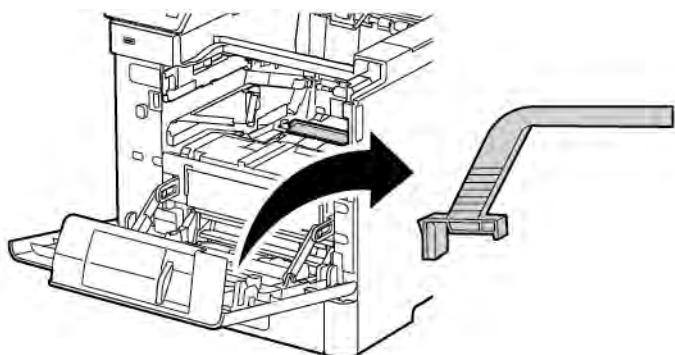
5. Снимите чистящую подушку с приспособления, нажав на два выступа. Обеспечьте правильную утилизацию использованной чистящей подушки.
