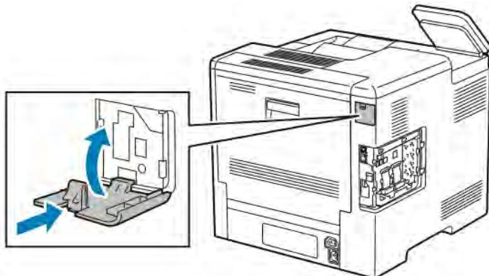
6. Установите на место левую крышку и сдвиньте ее к передней части принтера.
