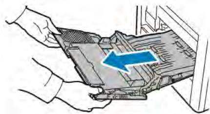
3. Выдвиньте лоток 1 из принтера.
