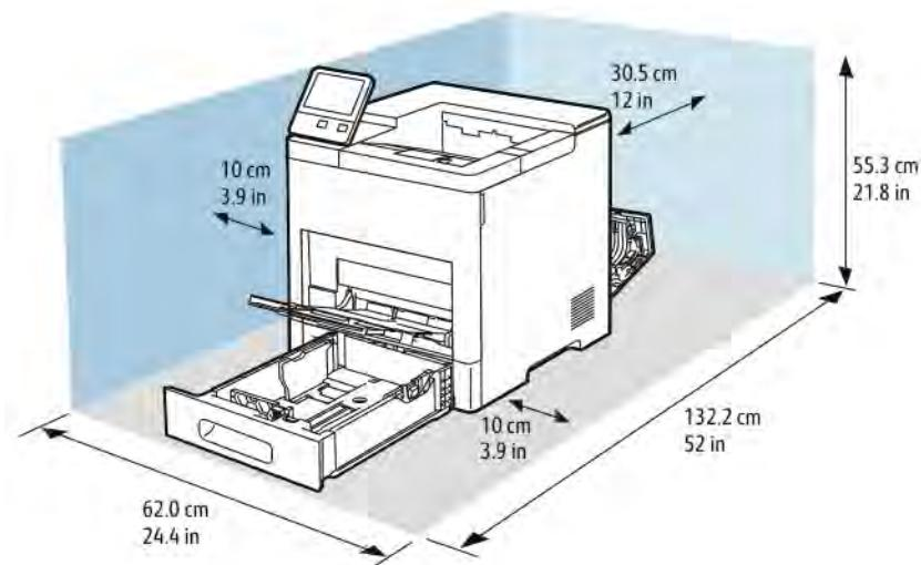
**Габаритные требования для базовой комплектации с дополнительным финишером**
