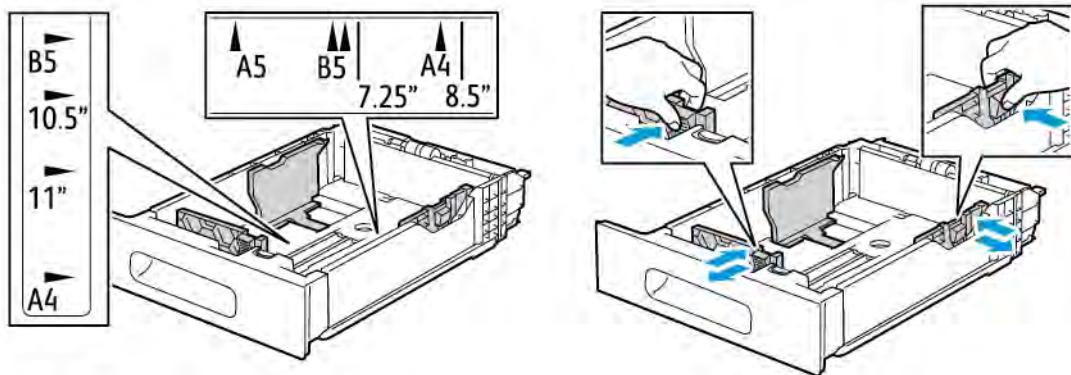
3. Для бумаги формата Legal: чтобы выдвинуть переднюю часть лотка, прижмите зеленую защелку и выдвиньте лоток.
