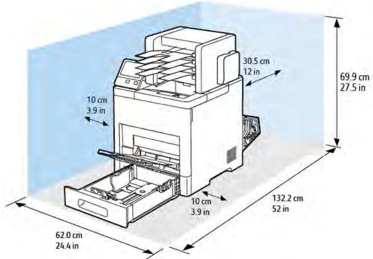
**Габаритные требования для базовой комплектации с дополнительным почтовым ящиком с четырьмя ячейками**
