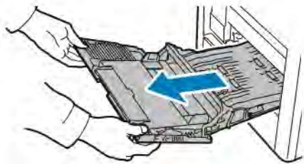
3. Выдвиньте лоток 1 из принтера.
