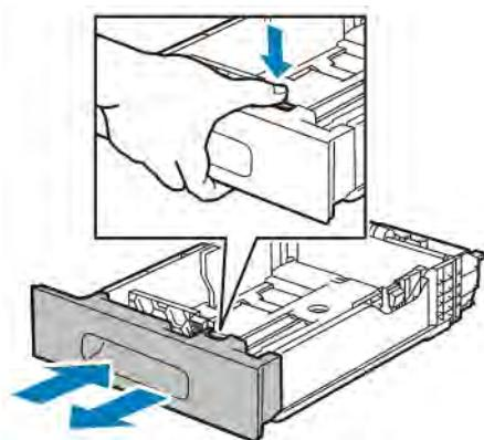
4. Чтобы раздвинуть лоток под бумагу большей длины, возьмитесь одной рукой за его заднюю часть. Другой рукой прижмите защелку в передней части лотка и выдвиньте его крайнюю часть до фиксации.
