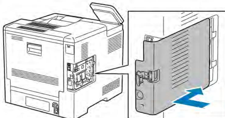
7. Для фиксации крышки поверните защелку к передней стороне принтера и прижмите защелку, чтобы она зафиксировалась со щелчком.
