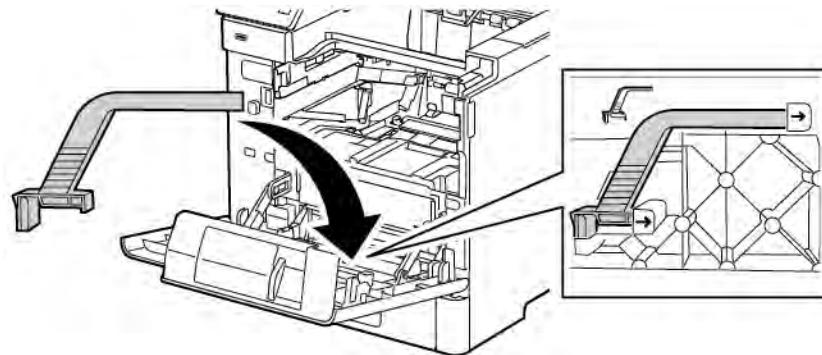
9. Установите принт-картридж в принтер до упора.
