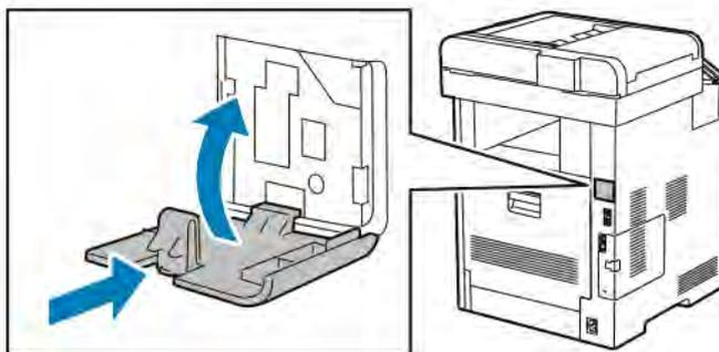
6. Die linke Seitenabdeckung einsetzen und dann zur Vorderseite des Druckers hin einschieben.
