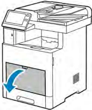
2. Für größere Materialformate Erweiterung der Zusatzzufuhr herausziehen und öffnen.
