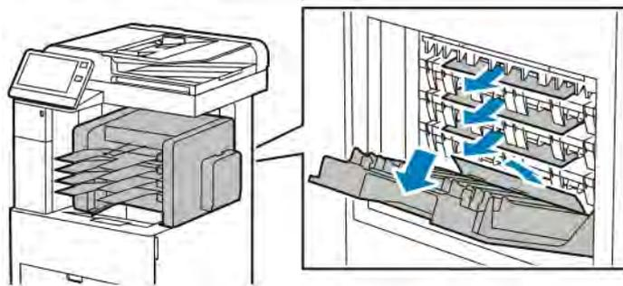
2. Die Stauzugangsabdeckung schließen. Zum Beheben weiterhin bestehender Probleme die Anweisungen am Steuerpult befolgen.
