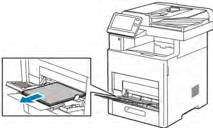
2. Die Zusatzzufuhr an beiden Seiten anfassen und gerade aus dem Drucker herausziehen.
