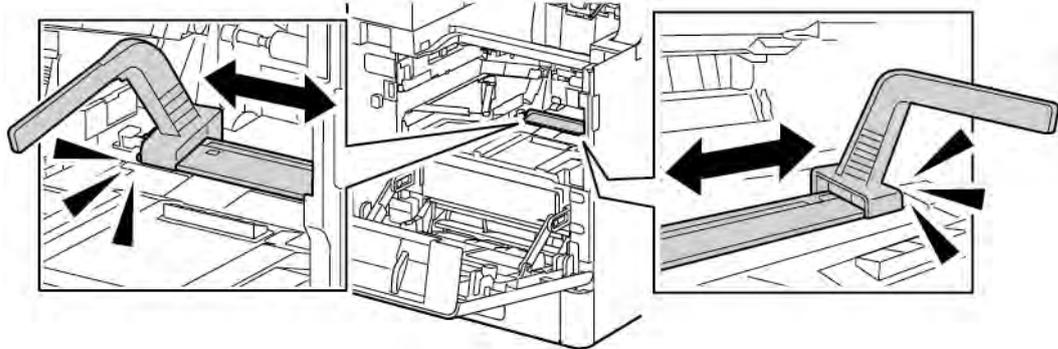
8. Den Reinigungsstab wieder an der Innenseite der vorderen Abdeckung unterbringen.
