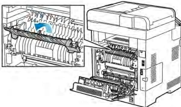
3. Gestautes Material an der Rückseite des Druckers entfernen.
