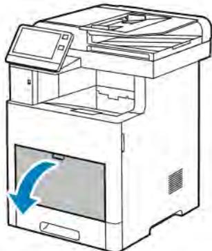
2. Für größere Materialformate Erweiterung der Zusatzzufuhr herausziehen und öffnen.
