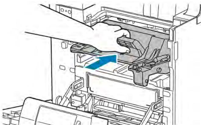
10. Das Tonermodul bis zum Anschlag in den Drucker schieben.
