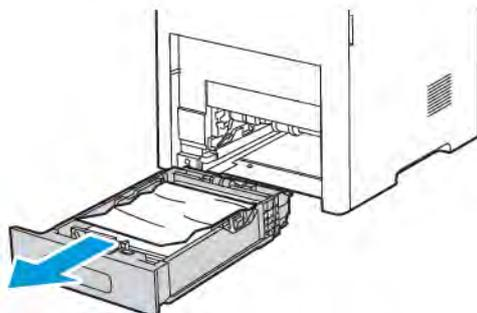
4. Zerknittertes Material aus dem Behälter und ggf. verbliebenes gestautes Material aus dem Drucker entfernen.
