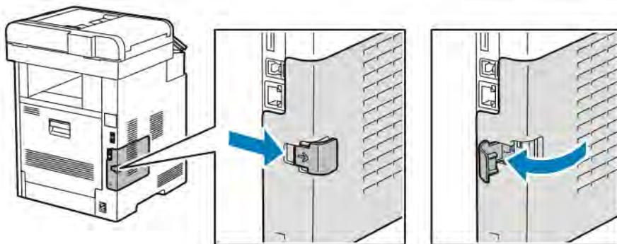
3. Die Abdeckung zur Rückseite hin aus dem Drucker herauschieben.
