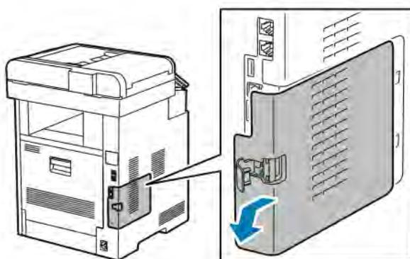
4. Im Gerät den Entriegelungshebel zur Vorderseite des Druckers hin drücken. Den Entriegelungshebel in dieser Position festhalten und den WLAN-Adapter vorsichtig herausziehen.
