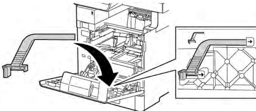
9. Die Trommeleinheit bis zum Anschlag in den Drucker schieben.
