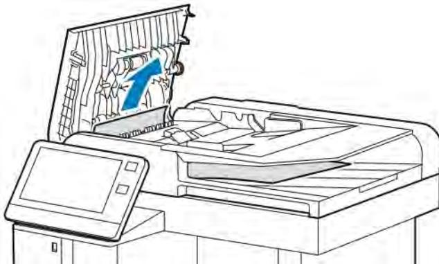
2. Ist Material im automatischen Duplex-Vorlageneinzug gestaut, die Vorlagenabdeckung öffnen.
