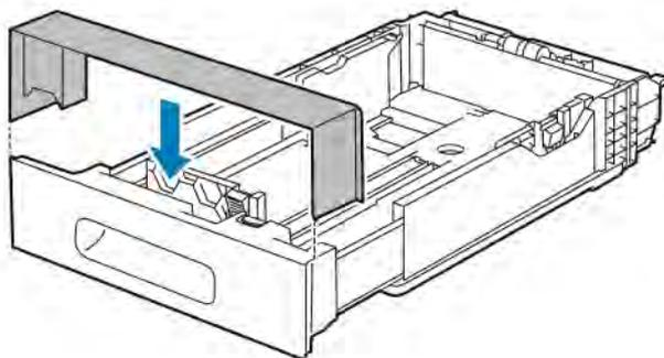
6. Material in den Behälter einlegen, dann Behälter wieder in den Drucker einschieben.
