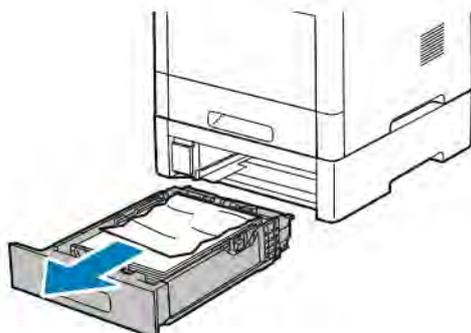
3. Zerknittertes Material aus dem Behälter und gegebenenfalls verbliebenes gestautes Material vorn aus dem Drucker entfernen.
