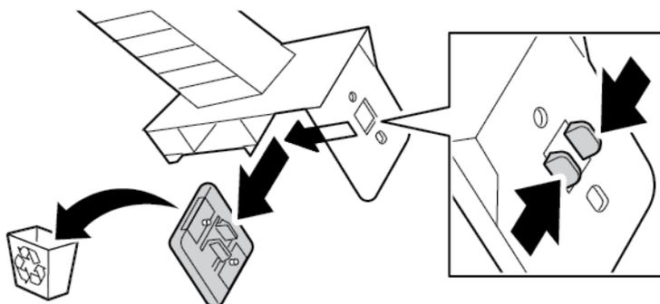
7. Για να αφαιρέσετε τυχόν ακαθαρσίες ή σκόνη γραφίτη, τοποθετήστε το εργαλείο καθαρισμού πάνω στο τμήμα του φακού LED. Σύρετε το εργαλείο καθαρισμού μέχρι να σταματήσει στο ένα άκρο του τμήματος του φακού LED. Στη συνέχεια, σύρετε το εργαλείο καθαρισμού προς την άλλη κατεύθυνση μέχρι να σταματήσει στο αντίθετο άκρο. Επαναλάβετε αυτήν την κίνηση ακόμα δύο φορές.
