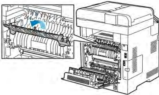
3. Αφαιρέστε τυχόν μπλοκαρισμένο χαρτί από το πίσω μέρος του εκτυπωτή.
