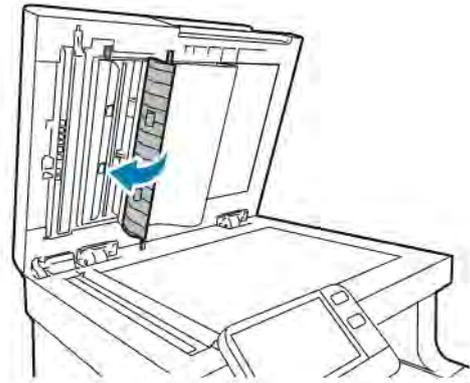
5. Κλείστε το κάλυμμα της επιφάνειας σάρωσης κι έπειτα επανατοποθετήστε το έγγραφο στον αυτόματο τροφοδότη εγγράφων διπλής όψης.
