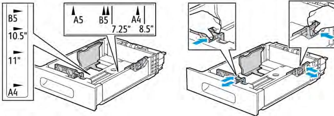
4. Τοποθετήστε τους φακέλους στους δίσκους με τα πτερύγια κλειστά, την όψη πτερυγίων προς τα κάτω και τη μικρή πλευρά να εισέρχεται στον εκτυπωτή.
