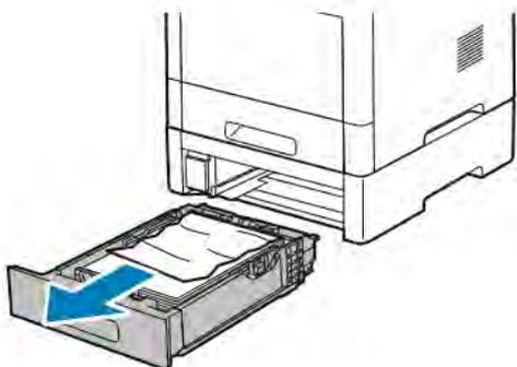
3. Αφαιρέστε τυχόν τσαλακωμένο χαρτί από το δίσκο και τυχόν υπολειπόμενο χαρτί που έχει μπλοκαριστεί στο μπροστινό μέρος του εκτυπωτή.
