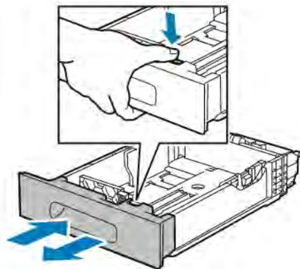
4. Για επέκταση του δίσκου για τοποθέτηση μεγαλύτερου χαρτιού, κρατήστε το πίσω μέρος του δίσκου με το ένα χέρι. Με το άλλο χέρι, πατήστε το μάνταλο απασφάλισης στο μπροστινό μέρος του δίσκου και, στη συνέχεια, τραβήξτε τις άκρες προς τα έξω έως ότου ασφαλίσουν.
