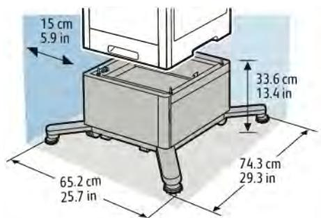
**Pristupni zahtjevi za dodatni uređaj za ulaganje visokog kapaciteta s kotačićima**
