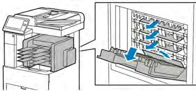
2. Zatvorite vrata za pristup zastolu. Za uklanjanje svih preostalih pogrešaka slijedite upute na upravljačkoj ploči.
