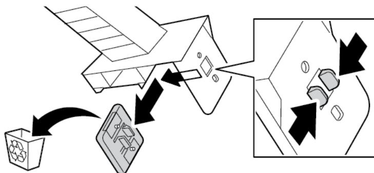
7. Uklonite ostatke i prašinu od tonera tako da postavite alat za čišćenje na blok LED leće. Vucite alat za čišćenje dok se ne zaustavi na kraju bloka LED leće. Zatim ga vucite u drugom smjeru dok se ne zaustavi na suprotnom kraju. Ponovite taj potez još dvaput.
