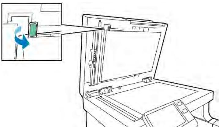
8. Mekom krpom navlaženom vodom obrišite staklo, bijelu plastičnu traku i valjke. Ako je prljavštinu teško ukloniti, navlažite meku krupu malom količinom neutralnog deterdženta pa osušite dijelove pisača mekom krpom.
