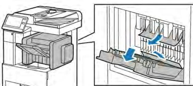
2. Zatvorite vrata za pristup zastoju. Za uklanjanje svih preostalih pogrešaka slijedite upute na upravljačkoj ploči.
