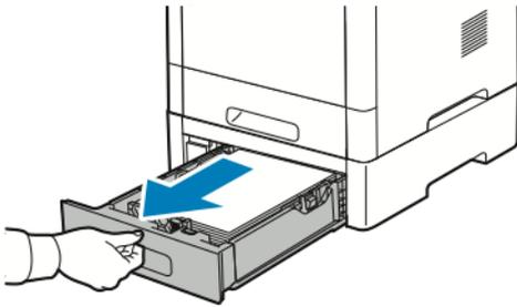
2. Щоб вийняти лоток, підніміть трохи його передню частину, тоді витягніть його з принтера.
