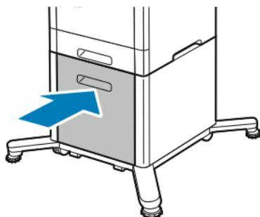
5. Якщо для режиму лотка встановлено режим із можливістю повного регулювання, принтер запропонує встановити тип, розмір і колір паперу.
