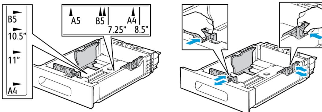
4. Завантажте конверти в лотки закритим клапаном донизу і коротшим краєм у напрямку подачі у принтер.
