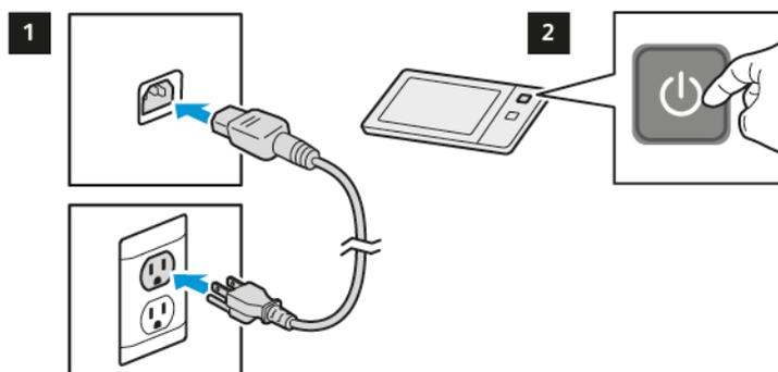
**⚠ ATTENTION ! DOMMAGE POTENTIEL :** Pour éviter tout risque d'incendie ou d'électrocution, branchez le cordon d'alimentation sur une prise électrique à la tension nominale appropriée et correctement mise à la terre, située à proximité du périphérique et facilement accessible.
