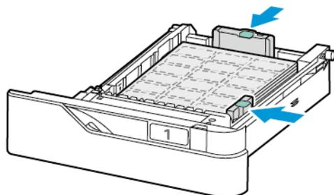
**Avertissement !** Veillez à ce que la pile ne dépasse pas la ligne de remplissage maximal. La surcharge de papier peut entraîner des incidents.
