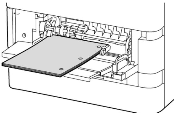
6. Réglez les guides de largeur pour les mettre légèrement en contact avec les bords du papier.
