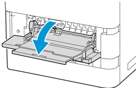
Chargez les étiquettes face dessus dans le départ manuel avec le bord inférieur vers le sens départ du magasin. Ajustez la longueur et la largeur des guides papier pour qu'ils correspondent aux étiquettes.
