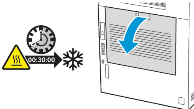
**ATTENTION ! SURFACE CHAUDE :** L'intérieur de l'imprimante peut être brûlant. Pour réduire le risque de blessure par un composant brûlant, laissez la surface refroidir avant de la toucher.
