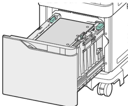
**Avertissement !** Veillez à ce que la pile ne dépasse pas la ligne de remplissage maximal. La surcharge de papier peut entraîner des incidents.
