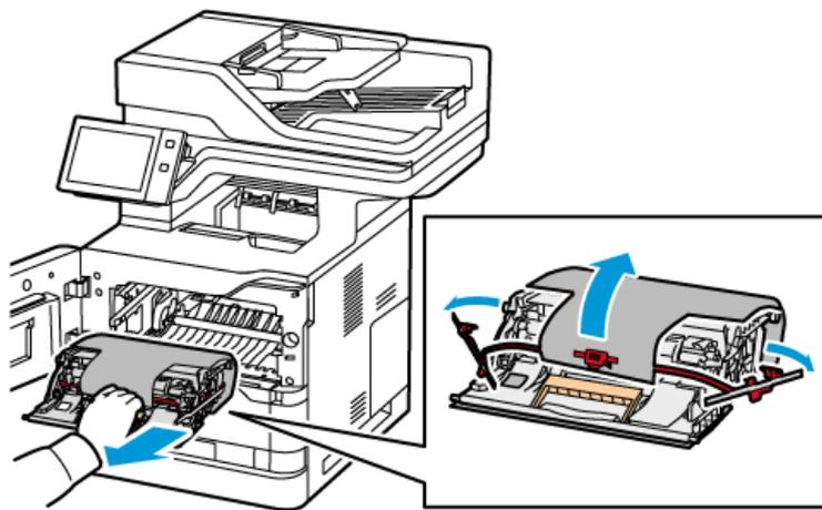
4. Coloque a unidade de tratamento de imagem e o cartucho de toner de volta em suas posições originais.
