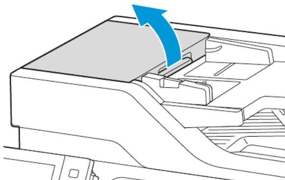
3. Para remover o rolo separador do alimentador de originais, destrave e remova a tampa do rolo separador para cima, como mostrado e depois retire o rolo separador usado.
