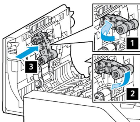
6. Para remover o rolo de alimentação do alimentador automático de originais 2, puxe o rolo de alimentação 1 e pressione o rolo de alimentação 2. Deslize o rolo de alimentação 2 para a esquerda e depois retire-o da tampa superior do alimentador automático de originais.
