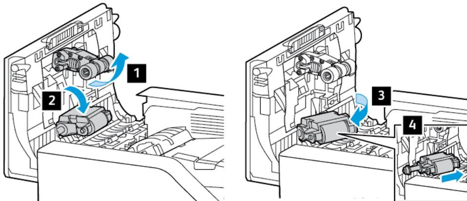
7. Desembale e insira o novo rolo de alimentação do alimentador automático de originais 2. Em seguida, coloque o rolo de alimentação 1 de volta na posição.
