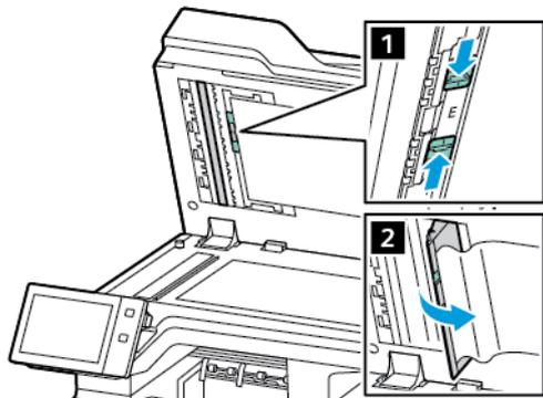
2. Com o uso de um pano macio e livre de fiapos umedecido com água, limpe o vidro espelhado, a tira de metal, ambos os lados da tira de plástico branco e os rolos. Se a sujeira for difícil de remover, umedeça o pano com uma pequena quantidade de detergente neutro e depois limpe as peças com um pano macio e seco.
