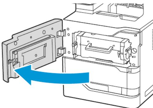
2. Segure firmemente a alça do cartucho e depois retire o cartucho de toner usado da impressora.
