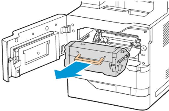
3. Remova a unidade de tratamento de imagem usada da impressora.
