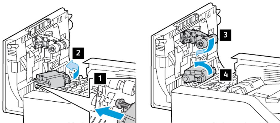
8. Insira a tampa do rolo de alimentação do alimentador automático de originais direcionada para baixo, conforme mostrado.
