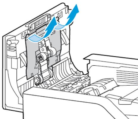
4. Para remover o rolo de alimentação do alimentador automático de originais usado 1, pressione a lingueta lateral para destravá-lo e depois deslize-o para cima para retirá-lo da tampa superior do alimentador de originais.
