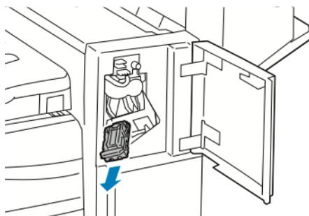
5. Vérifiez si des agrafes se trouvent à l'intérieur du module de finition et retirez-les.
