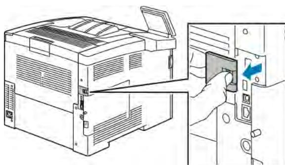
3. Før hånden inn i skriveren og trekk i utløserhendelen. Ta tak i den trådløse nettverksadapteren med den andre hånden og trekk den forsiktig vekk fra skriveren.
