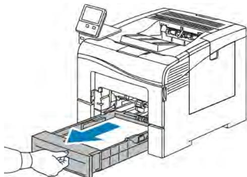
4. For å fjerne magasinet løfter du fremre ende av magasinet litt opp, før du trekker det ut av skriveren.
