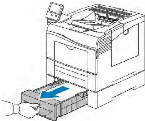
2. For å fjerne magasinet løfter du fremre ende av magasinet litt opp, før du trekker det ut av skriveren.
