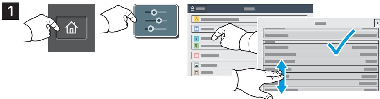
Verifique o endereço IP da impressora na tela de seleção por toque. Se o endereço IP não aparecer na parte superior da tela de seleção por toque, pressione Página inicial, toque em **Dispositivo** > **Sobre** e role para verificar o endereço IP.
