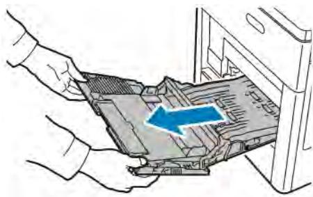
3. Выдвиньте лоток 1 из принтера.
