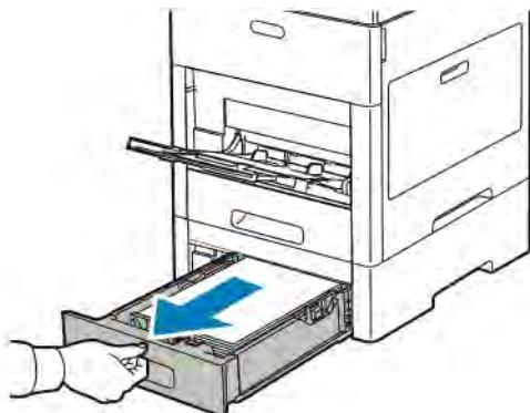
2. Чтобы снять лоток, слегка приподнимите его переднюю часть и снимите с принтера.
