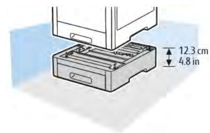
**Габаритные требования для принтера с дополнительной тумбой на колесиках**
