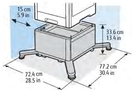
**Габаритные требования для дополнительного податчика большой емкости на колесиках**
