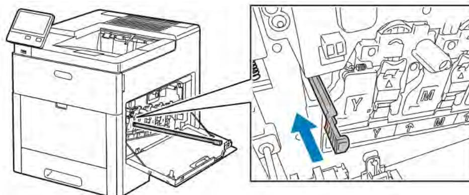
10. Чтобы установить сборник отходов, вставьте на место его нижнюю часть. Зафиксируйте сборник, прижав верхнюю часть до щелчка.
