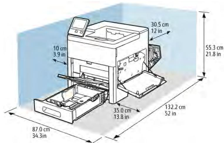
Габаритные требования для принтера с дополнительным податчиком на 550 листов
