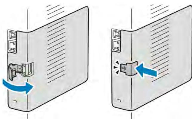
8. Подключите принтер к компьютеру с помощью кабеля USB или Ethernet.
