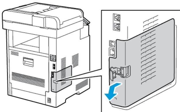
4. Infilare le mani nella stampante e spingere la leva di rilascio verso il lato anteriore della stampante. Mantenere la leva di rilascio in questa posizione mentre si tira l'adattatore di rete wireless per estrarlo dalla stampante.
