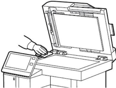
6. Strofinare la parte inferiore bianca della copertura finché non è pulita e asciutta.
