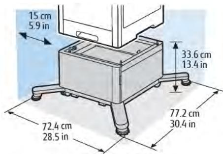
**Requisiti di spazio per l'alimentatore ad alta capacità (HCF) opzionale con rotelle**
