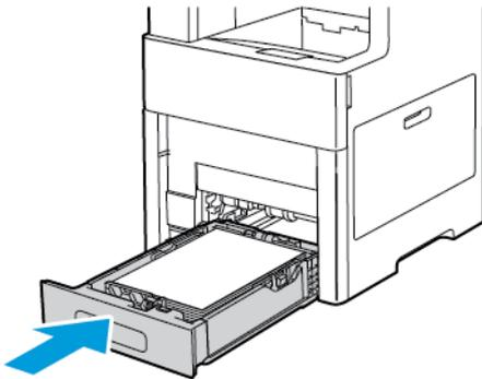
6. Inserire il vassoio bypass completamente nella stampante.
