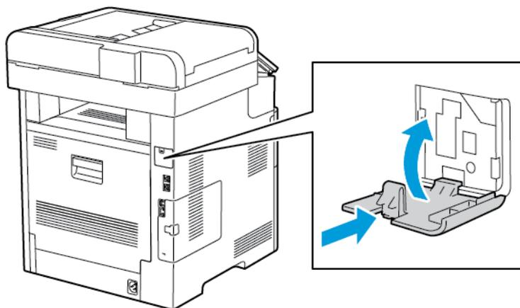
6. Reinstallare la copertura sinistra e farla scivolare verso la parte anteriore della stampante.
