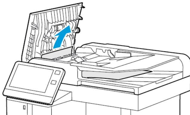
2. Se la carta è inceppata nell'alimentatore automatico fronte/retro con passaggio singolo, aprire la copertura dell'alimentatore.
