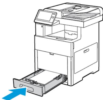
8. Se il vassoio è stato esteso per il formato carta Legal, il vassoio sporge quando è inserito completamente nella stampante. È possibile posizionare una copertura sull'area che sporge dal vassoio.
