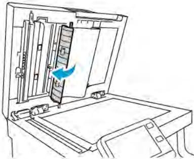
5. Chiudere la copertura dell'alimentatore e ricaricare il documento nell'alimentatore automatico fronte/retro.
