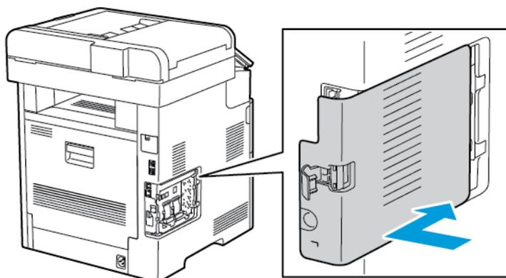
7. Per bloccare la copertura, ruotare la maniglia verso la parte anteriore della stampante, quindi spingere la maniglia finché non scatta in posizione di blocco.
