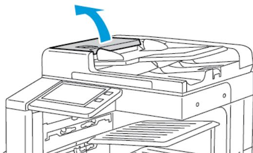
2. À l'aide d'un chiffon doux non pelucheux imbibé d'eau, essuyez les rouleaux d'entraînement jusqu'à ce qu'ils soient propres.
