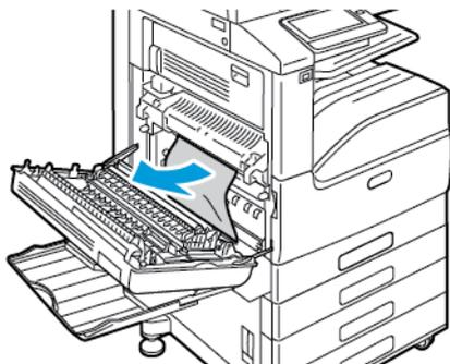
3. Si du papier est coincé à la sortie du bac récepteur, retirez-le en tirant droit avec soin selon la direction indiquée.
