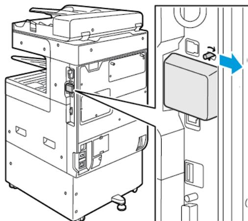
**!** **Attention :** Ne forcez pas pour retirer l'adaptateur réseau sans fil. Si le verrou est correctement actionné, l'adaptateur sort facilement. Tirer sur l'adaptateur peut l'endommager.
