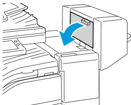
2. Si les cartouches d'agrafes ne sont pas visibles, saisissez les panneaux verticaux à gauche et à droite de l'ouverture et faites-les glisser vers le centre.
