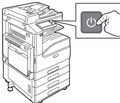
**!** **Attention :** Ne débranchez pas le cordon d'alimentation lors de la mise sous tension de l'imprimante.
