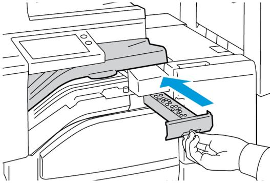
5. Fermez le capot supérieur du transport du module finition.
