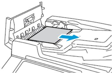
3. Si le message du panneau de commande vous demande d'ouvrir le panneau intérieur, soulevez le levier à languette verte pour ouvrir le panneau intérieur.
