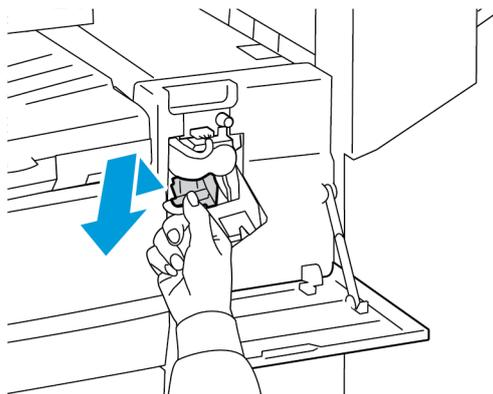
5. Vérifiez si des agrafes se trouvent à l'intérieur du module de finition et retirez-les.
