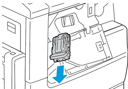
3. Vérifiez si des agrafes se trouvent à l'intérieur du module de finition et retirez-les.
