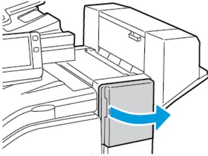
2. Mettez la main à l'intérieur du module de finition et tirez l'agrafeuse vers vous jusqu'à ce qu'elle se bloque.
