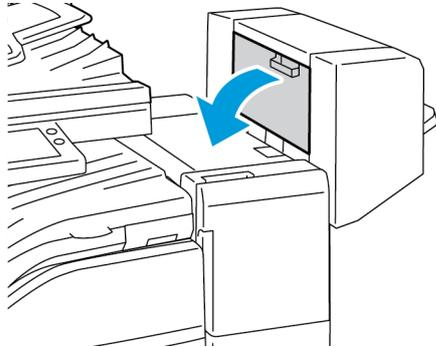
2. Si les cartouches d'agrafes ne sont pas visibles, saisissez les panneaux verticaux à gauche et à droite de l'ouverture et faites-les glisser vers le centre.
