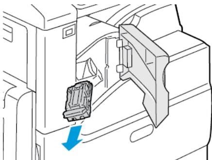
3. Vérifiez si des agrafes se trouvent à l'intérieur du module de finition et retirez-les.
