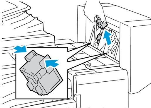
4. Saisissez les languettes situées de part et d'autre de la nouvelle cartouche d'agrafes neuve et insérez la cartouche dans la position originale dans le module de finition.
