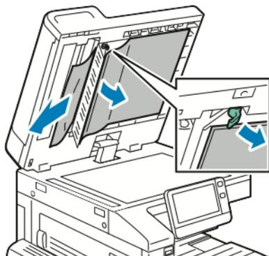
6. Ako izvorni dokument nije vidljiv nakon otvaranja uvlakača dokumenata zatvorite uvlakač dokumenata. Podignite ladicu uvlakača dokumenata, a zatim izvadite zaglavljene papir.
