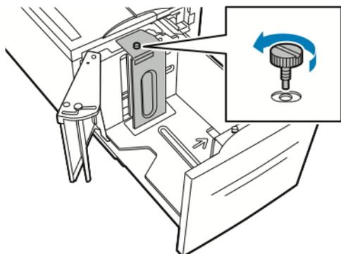
2. Za uklanjanje ploče odstojnika, uhvatite ju i podignite.
