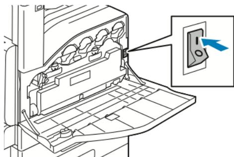
2. Na upravljačkoj ploči pisača pritisnite gumb **Napajanje/Buđenje**.
