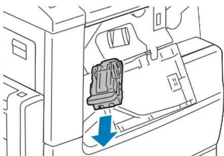
3. Provjerite ima li u unutrašnjosti finišera nepričvršćenih spjalica i uklonite ih.
