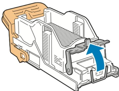
5. Izvadite zaglavljene spajalice, zatim gurajte spojnicu u prikazanom smjeru dok čvrsto ne sjedne na mjesto.
