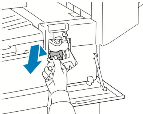
5. Provjerite ima li u finišeru nepričvršćenih spajalica pa ih uklonite.
