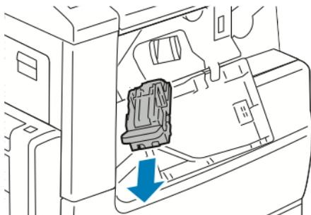
3. Provjerite ima li u finišeru nepričvršćenih spajalica pa ih uklonite.
