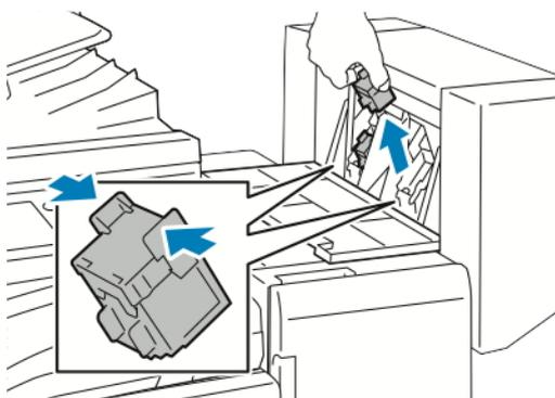
4. Za uklanjanje zaglavljenih spajalica povucite spjalice u prikazanom smjeru.
