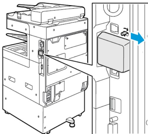
**Forsiktig:** Trekk ikke for hardt i den trådløse nettverksadapteren. Hvis du har brukt utløserhendelen riktig, vil adapteren lett komme ut. Hvis du trekker hardt i adapteren, kan du skade den.
