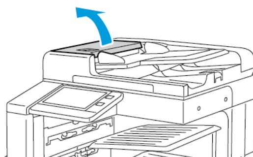
2. Hvis originaldokumentet ikke sitter fast i inngangen til den automatiske originalmateren, trekker du det rett ut i anvist retning.
