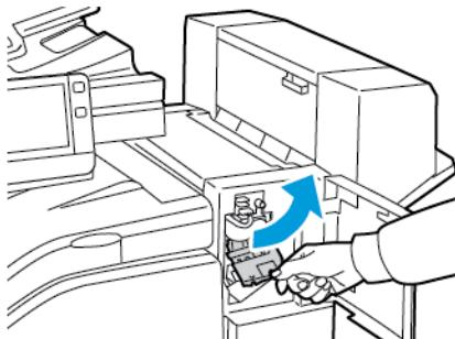
4. Ta tak i den oransje hendelen på stiftkassetten, og ta ut kassetten ved å trekke den bestemt mot deg.
