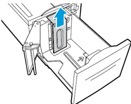
3. Sett knastene nederst på avstandsstykket inn i de sporene i bunnen av magasin 6 som tilsvarer papirformatet.
