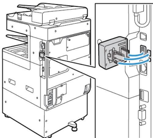
**Forsiktig:** Hvis du trekker hardt i adapteren, kan du skade den. Når adapteren er installert, bør du bare fjerne den etter behov og ved å følge instruksjonene for å fjerne den trådløse nettverksadapteren. Se [Demontere den trådløse nettverksadapteren](#) hvis du vil ha mer informasjon.
