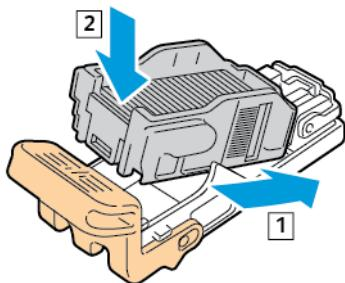
8. Ta tak i den oransje hendelen på stiftkassetten, og sett den inn i stiftermodulen. Skyv stiftekassetten inn inntil den klikker.
