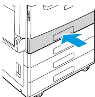
8. Velg papirformat, -type og -farge på kontrollpanelet. Pass på at papirtypen er stilt inn på Etiketter.
