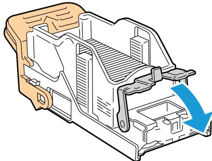
9. Ta tak i den oransje hendelen på stiftkassetten, og sett den inn i stiftermodulen. Skyv den inn til den smetter på plass.
