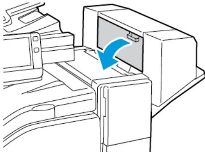
2. Hvis stiftekassetten ikke vises, må du gripe de vertikale panelene på hver side av åpningen og skyve stiftekassettene til midten.
