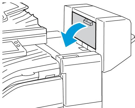
2. Hvis stiftekassettene ikke er synlige, griper du de vertikale panelene til venstre og høyre for åpningen og skyver panelene mot midten.
