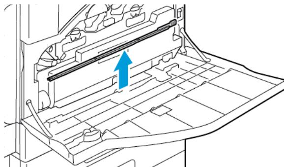
4. Skyv rengjøringsstaven sakte inn i skriveren til den stopper, og trekk den ut igjen. Gjenta dette to ganger til.
