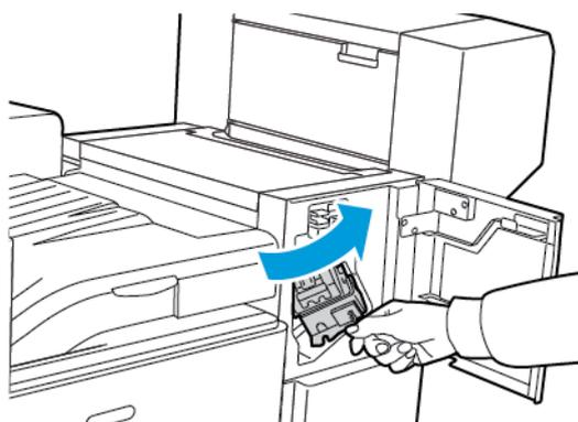
4. Zum Entfernen das Heftklammermagazin am orangefarbenen Griff fassen und fest nach vorne ziehen.
