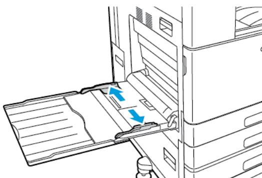
3. Τοποθετήστε χαρτί διαχωριστικών στο δίσκο. Τοποθετήστε χαρτί με τη μικρή πλευρά να εισέρχεται πρώτη στον εκτυπωτή.
