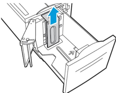
3. Τοποθετήστε τις γλωττίδες του κάτω μέρους της πλάκας διαχωρισμού στις σχισμές του κάτω μέρους του δίσκου 6 που αντιστοιχούν στο μέγεθος χαρτιού.
