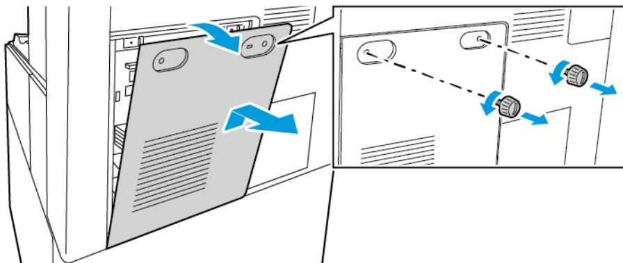
2. Για να επανατοποθετήσετε το κάλυμμα, τοποθετήστε τα κάτω άγκιστρα πάνω από τις υποδοχές στο πλαίσιο του εκτυπωτή. Ανασηκώστε το κάλυμμα στη θέση του και μετά επανατοποθετήστε τις δύο βίδες.
