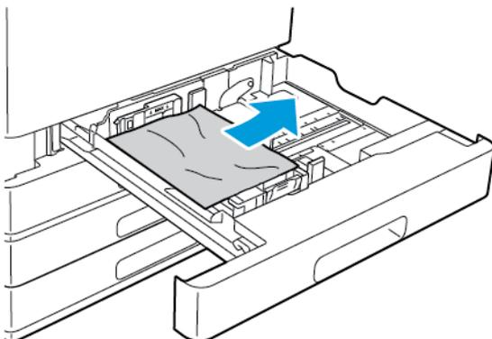
4. Se la carta è strappata, rimuovere completamente il vassoio e controllare che non siano rimasti dei frammenti all'interno della stampante.
