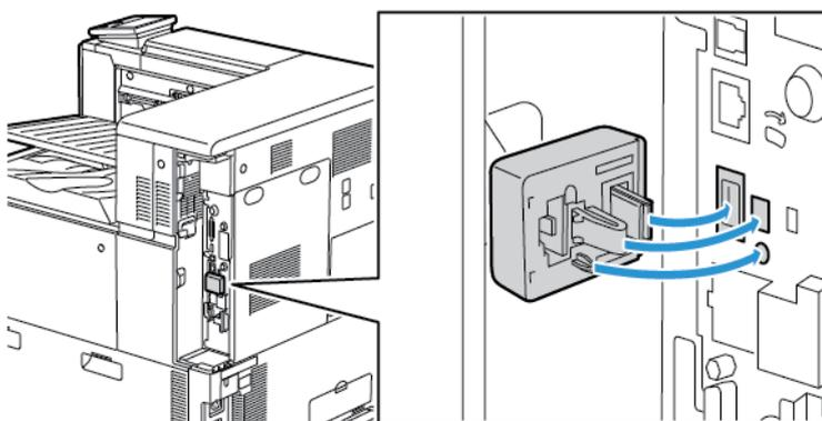
**!** **Attenzione:** Non tirare l'adattatore per evitare di danneggiarlo. Una volta installato l'adattatore, rimuoverlo solo in caso di necessità e seguendo le istruzioni fornite. Per maggiori dettagli, consultare [Rimozione dell'adattatore di rete wireless](#).
