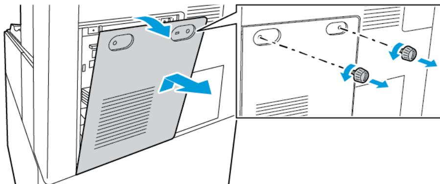
2. Per sostituire la copertura, collocare i ganci inferiori sugli slot nel telaio della stampante. Sollevare la copertura in posizione, quindi sostituire le due viti.
