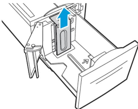
3. Inserire le linguette nella parte inferiore della piastra negli alloggiamenti nella parte inferiore del vassoio 6 corrispondenti al formato carta.
