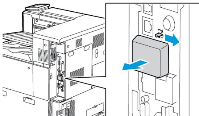
**!** **Attenzione:** Non esercitare una forza eccessiva per tirare l'adattatore di rete wireless. Se il fermo viene rilasciato correttamente, l'adattatore si estrae facilmente. Non tirare l'adattatore per evitare di danneggiarlo.
