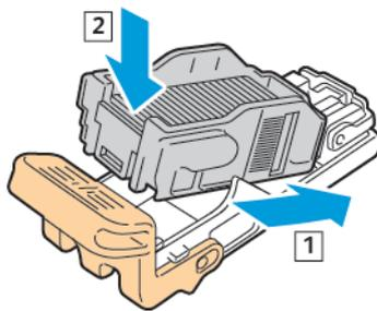
6. Tenendola per la maniglia arancione, inserire la nuova cartuccia pinzatrice nel complessivo della pinzatrice finché non si ascolta un clic.
