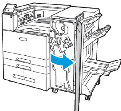
2. Rimuovere il contenitore dei residui di perforazione, etichettato con R4, dall'alloggiamento in alto a sinistra della stazione di finitura.
