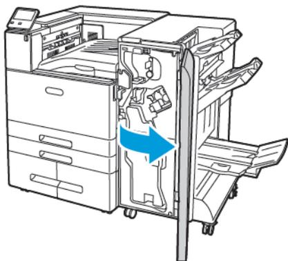
2. Tenendolo per la levetta arancione R1, spingere il complessivo pinzatrice a destra.
