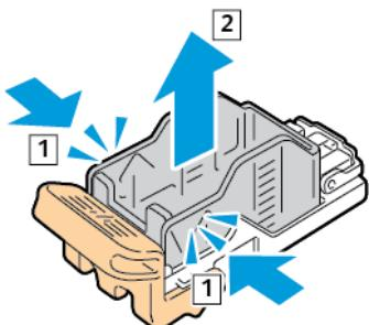
6. Вставте передню частину нової коробки зі скріпками в касету, а тоді втисніть у касету її задню частину.
