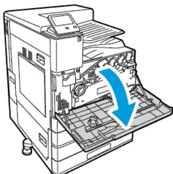
2. Вийміть модуль транспортування відпрацьованого тонера:
