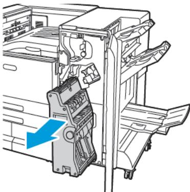
3. Щоб вийняти касету зшивача з брошурувальника, натисніть на ручку на касеті і потягніть касету назовні та вгору.
