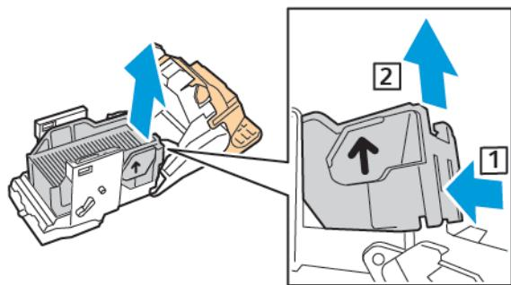
**Примітка:** Якщо застригла скріпка, відкрийте затискач на касеті зшивача.
