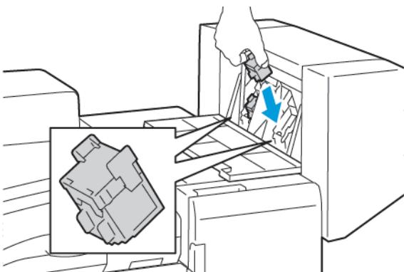
**Примітка:** Брошурувальник використовує дві касети зшивача. Для зшивання брошур потрібно, щоб скріпки були в обох касетах.
