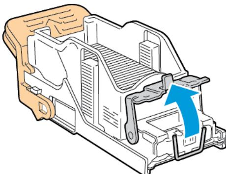
7. Вийміть застяглі скріпки і потисніть затискач у вказаному напрямку, доки він не зафіксується в положенні блокування.
