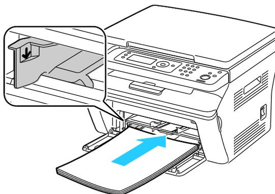
7. Réglez les guides de largeur pour les mettre légèrement en contact avec les bords du papier.
