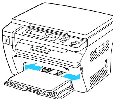
4. Courbez les feuilles d'avant en arrière et d'arrière en avant et ventilez-les, puis alignez les bords de la pile sur une surface plane afin de séparer les feuilles collées ensemble et de réduire le risque d'incidents papier.
