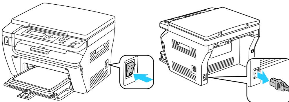
**AVVERTENZA:** per evitare scosse elettriche, non toccare mai il cavo di alimentazione con le mani bagnate. Quando si disinserisce il cavo di alimentazione della stampante, afferrare la spina e non il cavo per non danneggiarlo e causare incendi o scosse elettriche.
