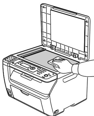
8. Strofinare la parte inferiore bianca della copertura della lastra finché non è pulita e asciutta.
