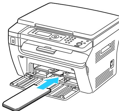
3. Сдвиньте направляющие для бумаги так, чтобы они слегка касались кромок конвертов.
