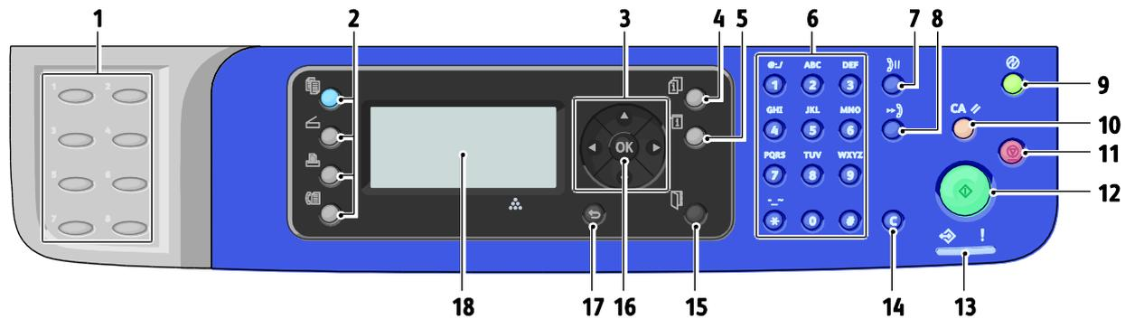
1. Клавиатура **ускоренного набора**: для ускоренного набора номеров телефона. Только для многофункционального принтера WorkCentre 3045NI.
