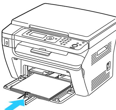
**Примечание:** В зависимости от формата бумаги сначала задвиньте ползунок до упора. Прижав направляющую длины, продвиньте ее к кромке бумаги.
