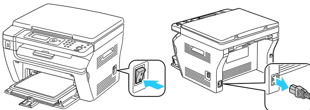
**⚠ ПРЕДУПРЕЖДЕНИЕ.** Для предотвращения поражения электрическим током запрещается касаться вилки шнура питания мокрыми руками. При отсоединении шнура питания обязательно тяните за вилку, а не за шнур. Если вы будете тянуть за шнур, то можете повредить его. Это может привести к возгоранию и поражению электрическим током.
