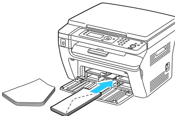
**Примечание:** Для того чтобы не морщились конверты № 10, Monarch и DL, их следует вкладывать печатной стороной вверх и с открытым клапаном, обращенными в сторону от принтера.
