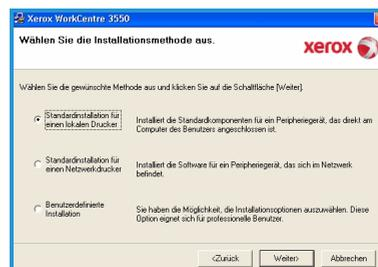
Falls der Drucker noch nicht an den Computer angeschlossen wurde, wird das Fenster *Gerät anschließen* angezeigt. Nachdem der Drucker angeschlossen wurde, auf **Weiter** klicken. Wenn der Drucker zu diesem Zeitpunkt nicht angeschlossen werden soll, auf **Weiter** und im folgenden Fenster auf **Nein** klicken. Die Installation wird gestartet, jedoch wird im Anschluss an die Installation keine Testseite ausgedruckt.
