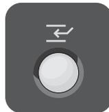
**Druckunterbrechung** hält den aktuellen Druckauftrag an, um einen dringenderen Auftrag auszuführen.
