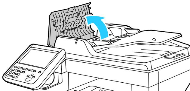
2. À l'aide d'un chiffon doux non pelucheux, essuyez les rouleaux d'entraînement et le patin de séparation jusqu'à ce qu'ils soient propres.
