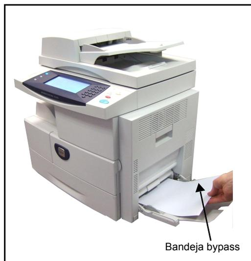
4. Ajuste a guia de papel de acordo com a largura da pilha do material de impressão. Certifique-se de que não colocou demasiadas folhas. A pilha deverá encontrar-se abaixo do indicador de limite máximo.
