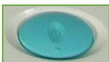
Pulse el botón **Comenzar**. La máquina escanea los originales, marca el número introducido e intenta conectarse con el fax remoto. Una vez conectada, la máquina local envía el trabajo de fax. Para imprimir un informe de confirmación o error, consulte *Informe de fax en el capítulo Configuración en la página 183*.
