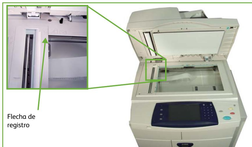
2. Coloque el original cara abajo sobre el cristal de exposición y alinéelo con la punta de la flecha de registro situada en la parte superior izquierda del cristal de exposición.
