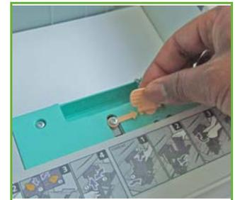
3. Desplace las guías laterales para ponerlas en la posición deseada. Alinee la flecha con el tamaño del papel deseado.
