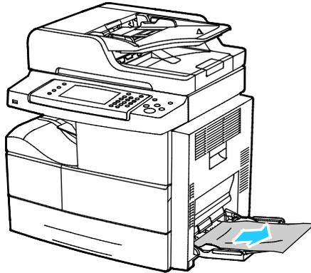
2. Se o papel estiver rasgado, verifique se há pedaços no interior da impressora e remova-os com cuidado. Se não conseguir remover os fragmentos de papel com facilidade, entre em contato com o representante Xerox.
