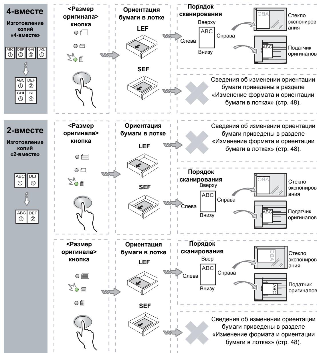
**Примечание •** Кнопка <Размер оригинала> недоступна при использовании податчика оригиналов, поскольку размер оригинала выбирается автоматически.
