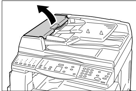
2. Поворачивая ролик податчика оригиналов, протрите его мягкой тканью, смоченной водой.
