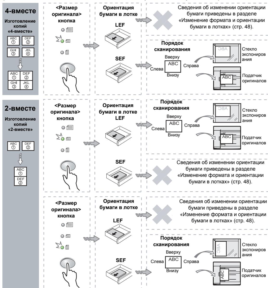
**Примечание •** Кнопка <Размер оригинала> недоступна при использовании податчика оригиналлов, поскольку размер оригинала выбирается автоматически.
