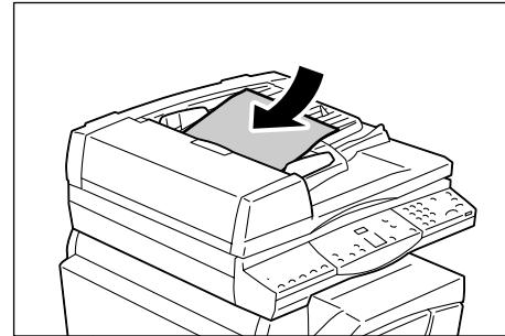
2) Отрегулируйте направляющие, чтобы они слегка касались кромок оригинала.
