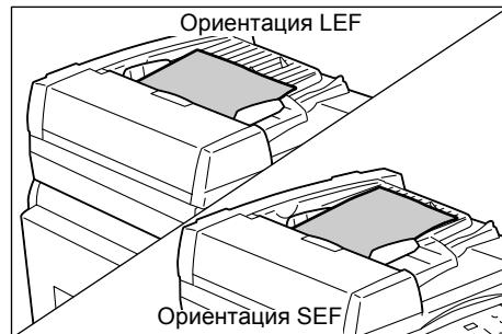
3. Отрегулируйте направляющие, чтобы они слегка касались кромок оригинала.
