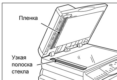
2. Чтобы очистить узкую полоску стекла, протрите её смоченной водой мягкой тканью и вытрите сухой тканью.
