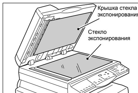
2. Чтобы очистить стекло экспонирования, протрите его смоченной водой мягкой тканью и вытрите сухой тканью.
