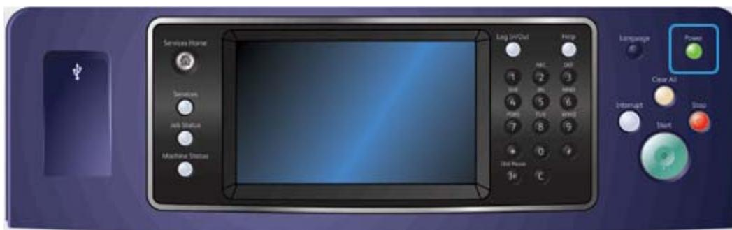
1. Pulse el botón **Encendido/Apagado** en el panel de control.
