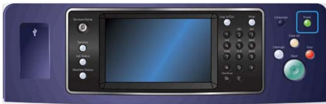
1. Pritisnite gumb **Napajanje** na upravljačkoj ploči.
