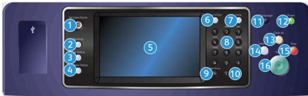
1. **Servisi početak:** Omogućuje pristup dostupnim uslugama uređaja.
