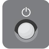
Для перехода в режим энергосбережения, перезагрузки или выключения принтера нажмите кнопку **Электропитание** на панели управления и выберите один из вариантов на сенсорном экране. Для выключения питания удерживайте данную кнопку несколько секунд.
