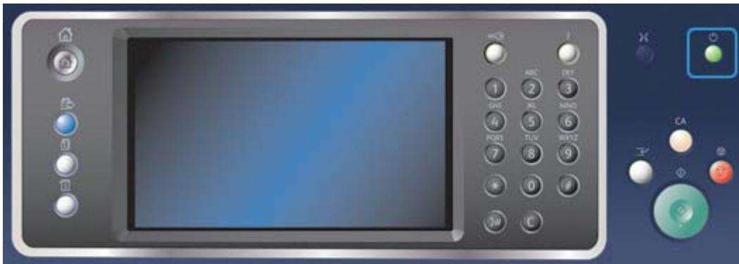
1. Pritisnite gumb **Napajanje** na upravljačkoj ploči.
