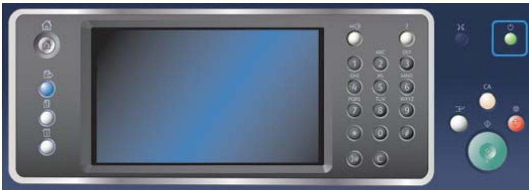
1. Pritisnite gumb **Napajanje** na upravljačkoj ploči.
