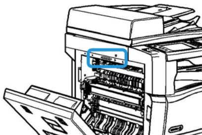
1. Podignite ručicu da biste otvorili vrata s lijeve strane uređaja. Lagano spustite vrata dok se ne zaustave.
