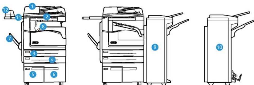
1. **Alimentatore automatico e lastra di esposizione:** utilizzati per scansionare uno o più documenti. La lastra di esposizione può essere utilizzata per scansionare documenti singoli, rilegati, di formato personalizzato o danneggiati.
