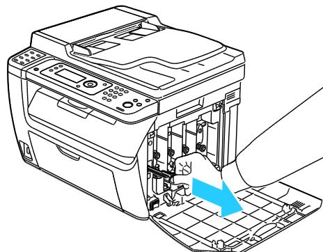
7. Vložte čisticí tyčinku do otvoru označeného šipkou uprostřed otvoru kazety s tonerem. Zatlačte čisticí tyčinku, dokud se nezastaví, a potom ji vytáhněte.
