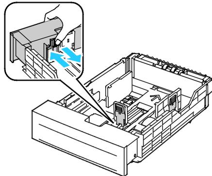
4. Zum Zusammenschieben des Behälters für kürzeres Material die Behälterrückseite mit einer Hand festhalten. Mit der anderen Hand vorne am Behälter auf die Entriegelungsklinke drücken und die Enden nach innen schieben, bis sie einrasten.
