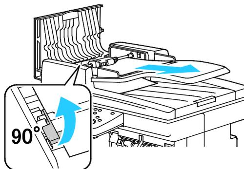
4. Lässt sich die Vorlage nicht leicht entfernen, Zuführrolleneinheit entfernen und Papier wie folgt entfernen:
