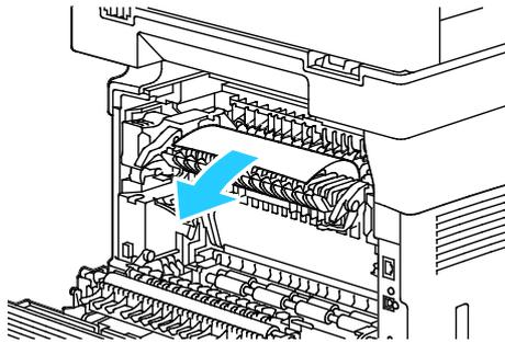
5. Materialführungsabdeckung am Fixiermodul schließen.
