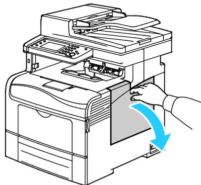
3. Zum Entriegeln des Tonersammelbehälters den Hebel um 90 Grad gegen den Uhrzeigersinn drehen.
