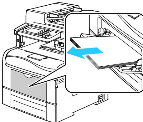
2. Die Zusatzzufuhr an beiden Seiten anfassen und gerade aus dem Drucker herausziehen.
