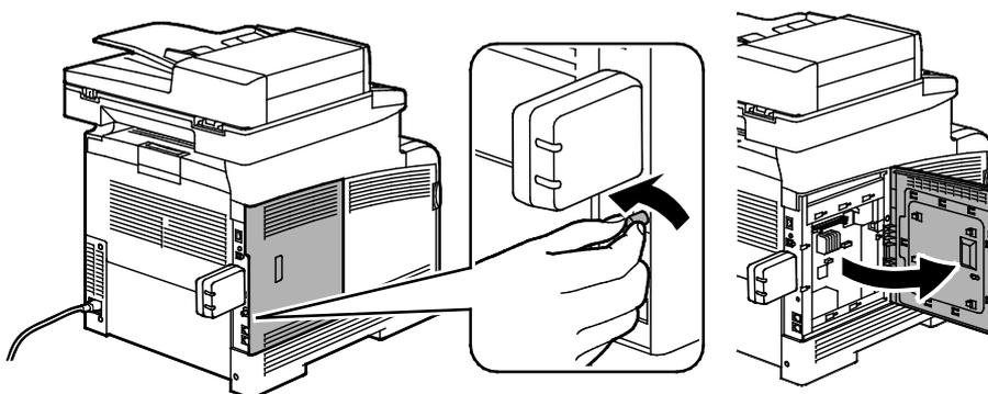
3. Die Plastik-Entriegelungsklinke am WLAN-Adapter suchen, der hinten am Gehäuse herausragt.
