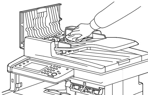
**Hinweis:** Werden die Zufuhrrollen des Duplex-Vorlageneinzugs durch Toner oder andere Fremdkörper verunreinigt, kann dies Flecken auf den Dokumenten zur Folge haben. Zum Entfernen der Verunreinigung ein weiches, fusselfreies Tuch verwenden, das mit einem neutralen Reinigungsmittel oder Wasser befeuchtet ist.
