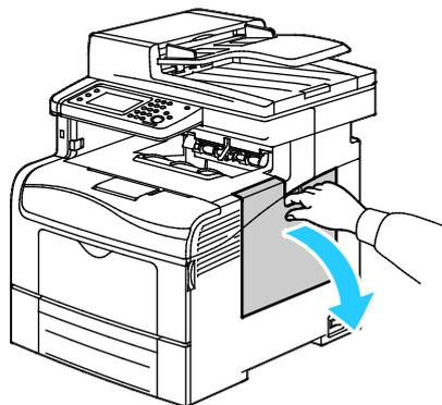
4. Zum Entriegeln des Tonersammelbehälters den Hebel um 90 Grad gegen den Uhrzeigersinn drehen.
