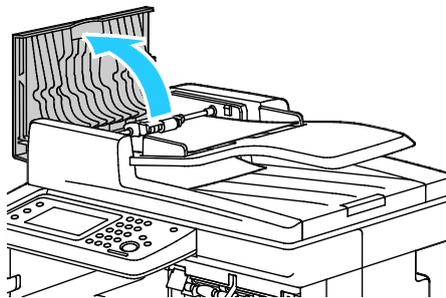
3. Den Entriegelungshebel um 90 Grad nach oben schwenken, dann das eingeklemmte Material vorsichtig in der gezeigten Richtung herausziehen (siehe Abbildung).
