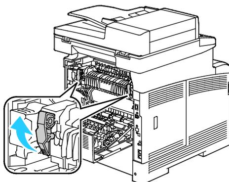
3. Zum Anheben der oberen Materialführungen oben in der Fixieranlage diese an den Griffen anheben und nach oben herausziehen.
