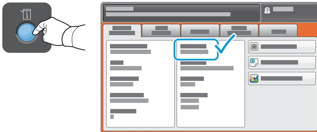
Se l'indirizzo IP non viene visualizzato nell'angolo superiore sinistro dello schermo sensibile, premere **Stato macchina** e controllare il campo di informazioni.
